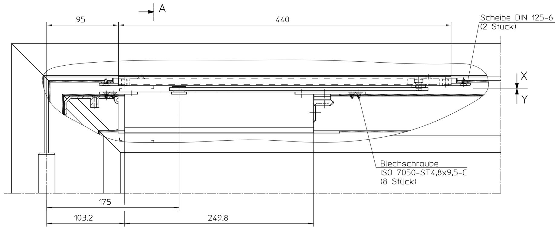
Maße GEZE Boxer Gr. 3-6 mit Gleitschiene 12mm
